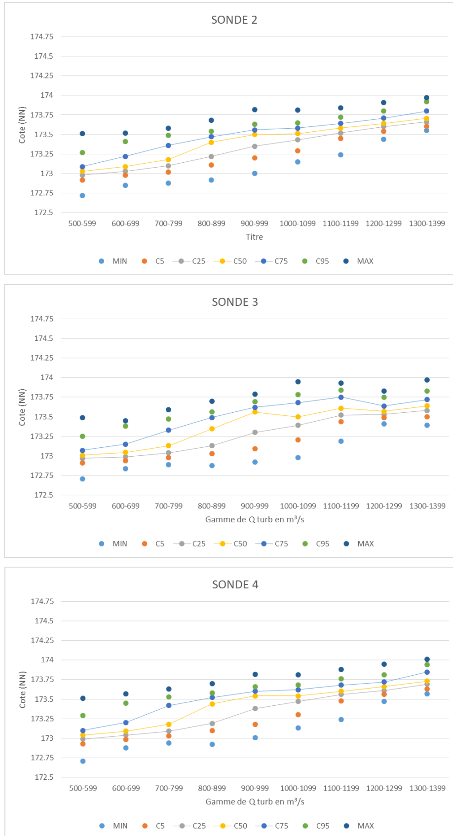
Figure 17 – Répartition statistique des niveaux aux sondes en fonction des débits turbinés
