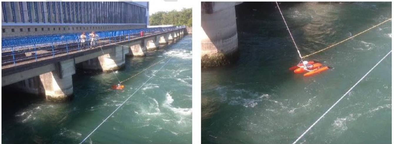
Figure 27 – Mesures de profils de vitesse en sortie des aspirateurs des turbines par mesure à l'ADCP
