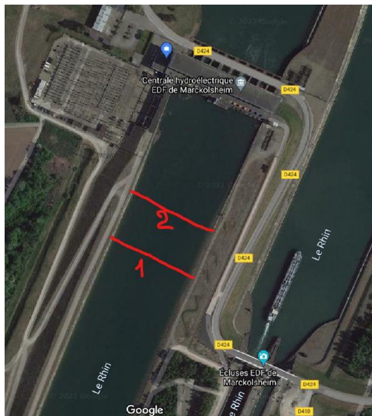
Figure 21 – Limites indicatives d'accumulation des corps flottants en amont de l'usine (trait 1 : quand un groupe de rive à l'arrêt ; trait 2 ; en général)
